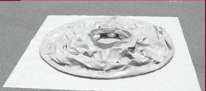
グランドシートの中心にウォータータンクを配置します。その際、底部にシワがよらないように広げ、さらにタンク上部の注水口のフロートが中央に円形になるよう配置します。
